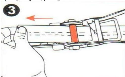
3. С помощью ручки замка, возвратно-поступательными движениями, натянуть ремень, сделав при этом не менее 1,5 - 3 полных оборотов барабана механизма.
