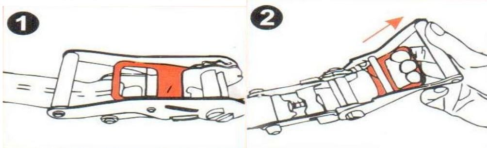
2. Ввести ленту в проем на барабане храпового замка и вручную протянуть на требуемую длину
